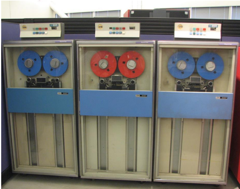
Bandstationen für IBM System 360 aus den 1960er Jahren
